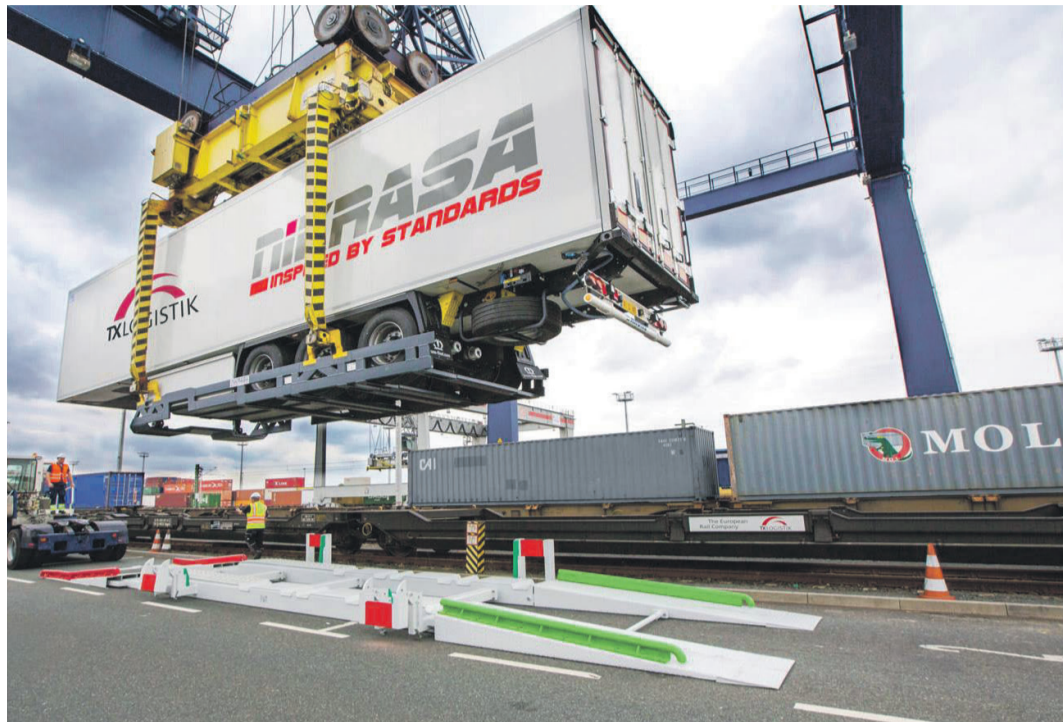
NiKRASA bringt Nicht KRAnbare Sattelaufleger einfach von der Straße auf die Schiene
