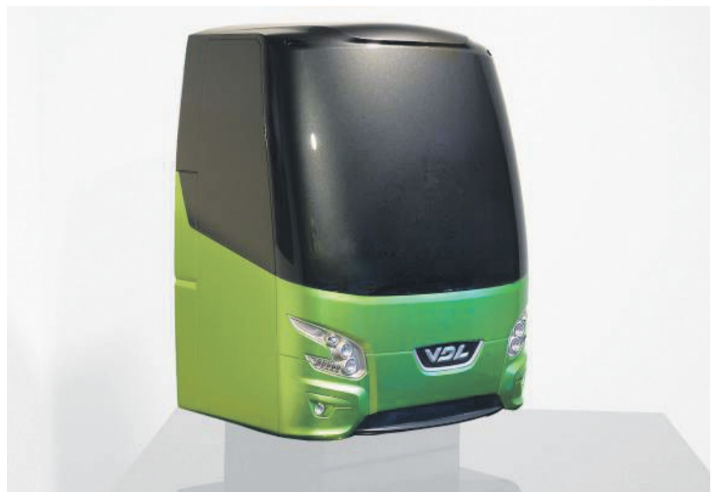
Skaliertes Modell einer Busfront
