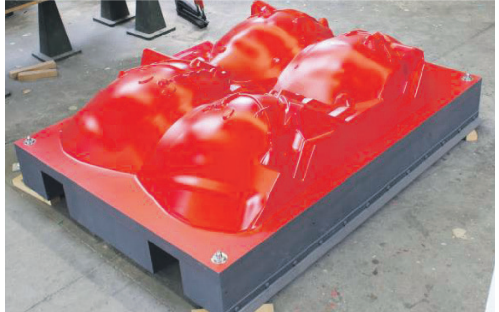
4-fach-Presswerkzeug aus Holz (lackiert) für Prototypen von Radlaufschalen
