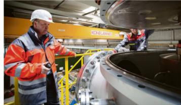
Vertikaler Dünnschichtverdampfer im Probebetrieb
