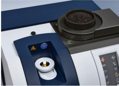
Der Multi Purpose Analyzer MPA der Bruker Optik für die Analyse von Ölen und Ölsaaten
