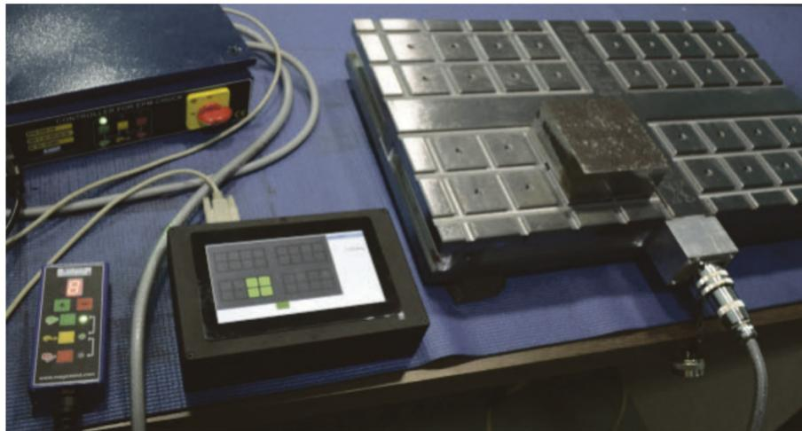
Dies geschieht alles, ohne dass permanent Strom fließt, sondern nur ein kurzer Stromimpuls zum EIN- und AUS-Schalten benötigt wird.
